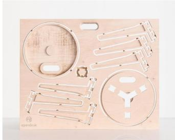
La découpe à la fraiseuse à commande numérique ne produit pas des pièces prêtes à l'usage. Les pièces découpées doivent rester solidaires à la plaque afin de ne pas se retrouver à voler à travers l'atelier. Il convient alors de couper manuellement des petites encoches, comme si l'on avait affaire à une grille de pièces en plastique injecté.
